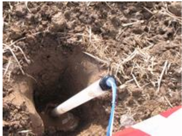
Aufbau der Saugkerzenanlage zur Beprobung des Sickerwassers (links) und Einschlämmen einer Saugkerze (rechts)
