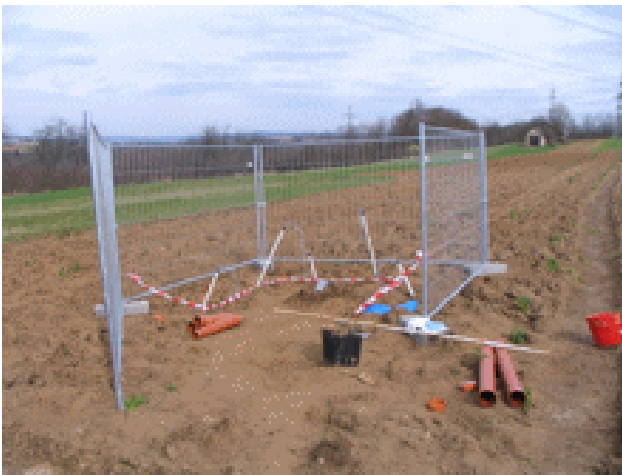
Aufbau der Saugkerzenanlage zur Beprobung des Sickerwassers (links) und Einschlämmen einer Saugkerze (rechts)
