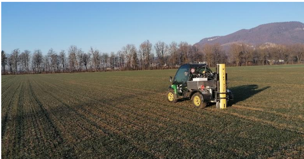
Abbildung 3: Mechanische Nmin-Probenahme. Pro Feld oder Sektor werden 12 – 15 Einstiche auf der Fläche in drei Horizonten (0 – 30 cm, 30 – 60 cm, 60 – 90 cm) vorgenommen. Probenahme am 25.02.2022 durch Sven Schönmann (Briner AG), Probenehmer im Nitratprojekt.
