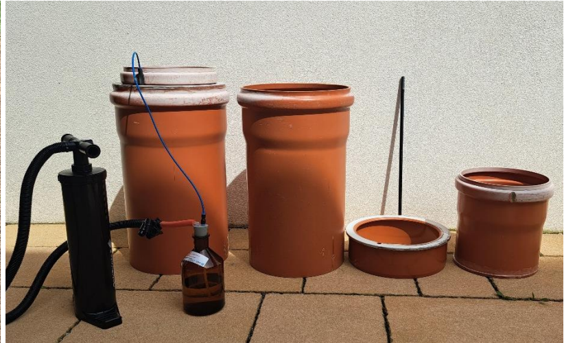
Abbildung 8: Links der Versuchsaufbau in der Nähe von Oensingen. Die Böden sind zufällig angeordnet. Das obere Bild zeigt den Aufbau der Lysimeter in Kombination mit der Beprobungseinrichtung.
